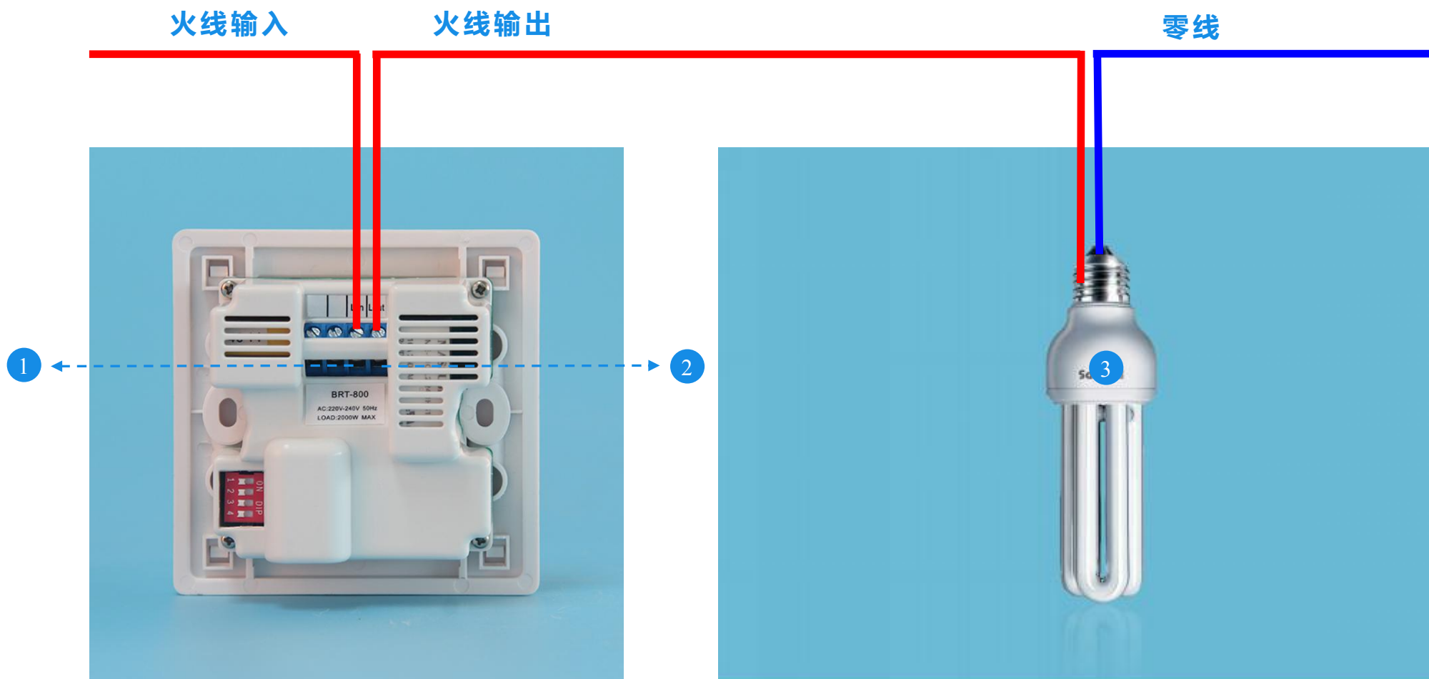
标注：① Lin：火线输入接口 ② ACL：火线输出接口 ③ 负载（灯具）
