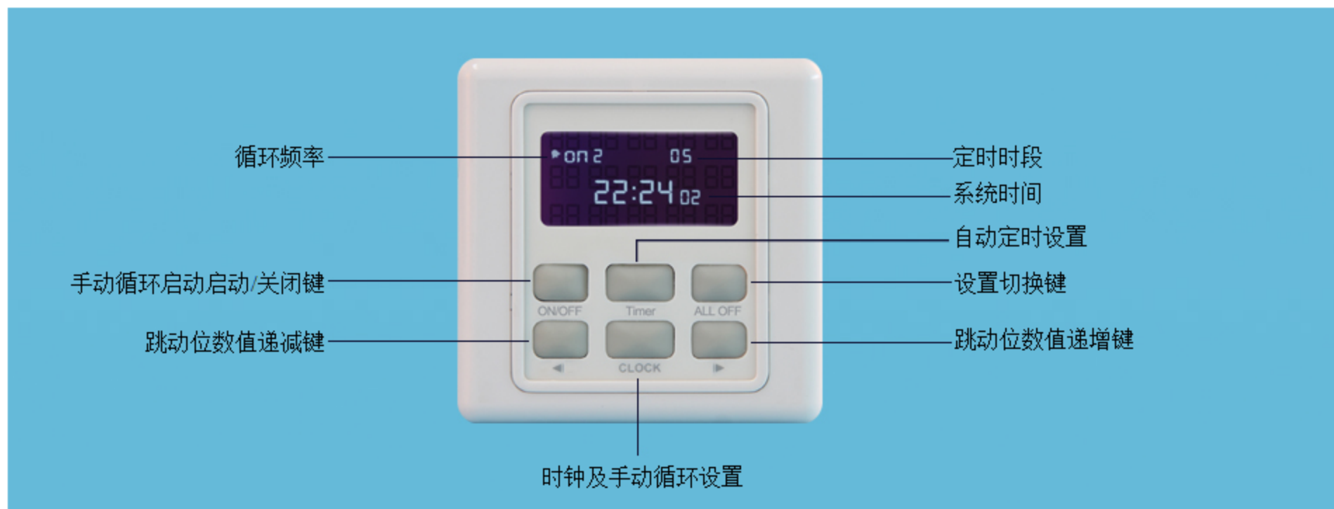
图六 开关面板各键功能示意图
